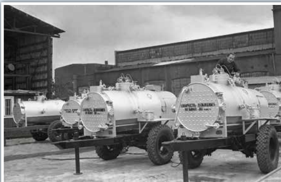
Котлы-парообразователи, изготовленные на заводе «Стройдормаш»
